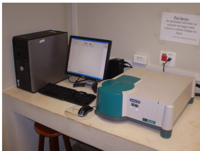
Figura 6: Espectrofotômetro de absorção molecular no UV-VIS, utilizado nas medidas in vitro .
