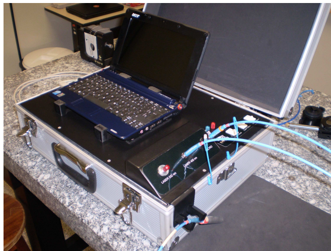
Figura 4: Espectrofluorímetro portátil composto por dois lasers, um monocromador, um laptop e uma fibra óptica do tipo Y.
