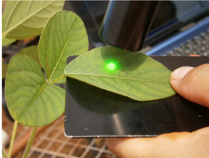
Figura 7: Medidas de fluorescência realizadas nas plantas in vivo , utilizando-se o espectrofluorímetro portátil.
