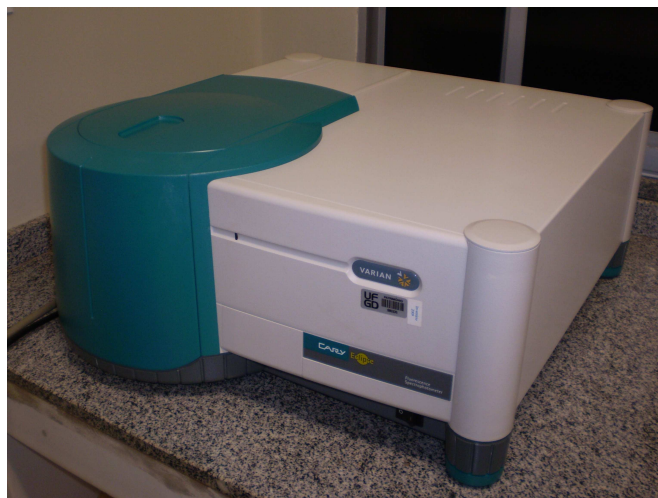
Figura 5: Espectrofotômetro de fluorescência utilizado nas medidas in vitro .
